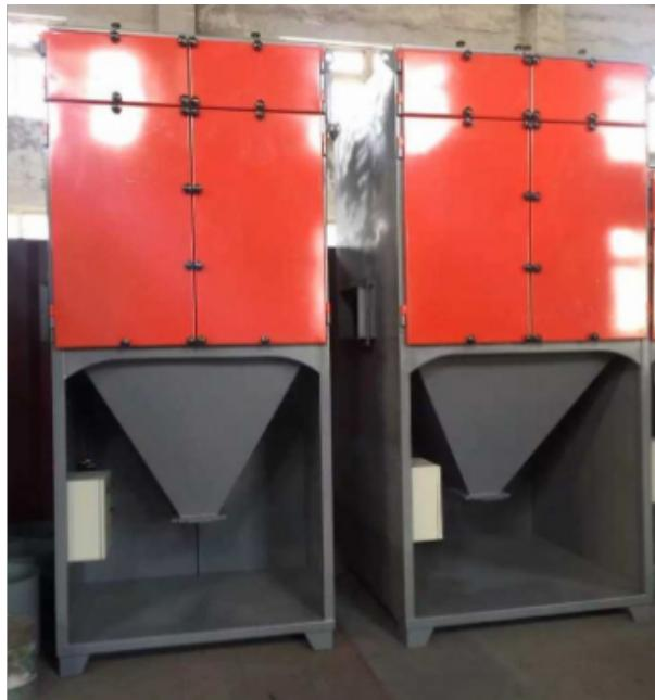
颗粒层除尘器以不同粒度的颗粒材料堆积层为滤料来阻隔过滤气溶中所含粉尘的设备。主要用在建材、冶金等生产过程中的排尘点，经常是过滤浓度高、颗粒粗、温度较高的含尘烟气。袋式除尘器，该过滤器是以纤维织造物或填充层为过滤介质的除尘装置，他的用途、形式、除尘风量规模和作用效率各方面都有宽阔的范围，主要用在捕集细微粉尘的场所，即在排气除尘系统上应用，又在进风系统上应用。近年来，由于新型滤材的不断开发，纤维过滤技术的发展也随之加速，新产品的不断出现，应用领域也日益的扩宽。
